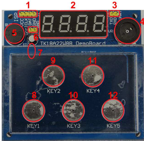
图 3.1 5 键触摸防水演示板正视图
